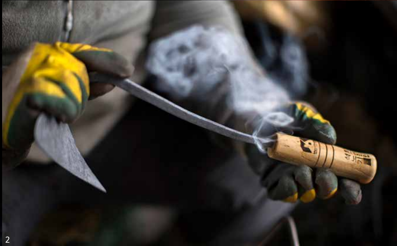
1 빨강게 달린 강철 조각을 꺼내고 있는 모습 2 호미 자루를 연결하는 모습 3 아마존에 올라온 석노기 장인의 호미
