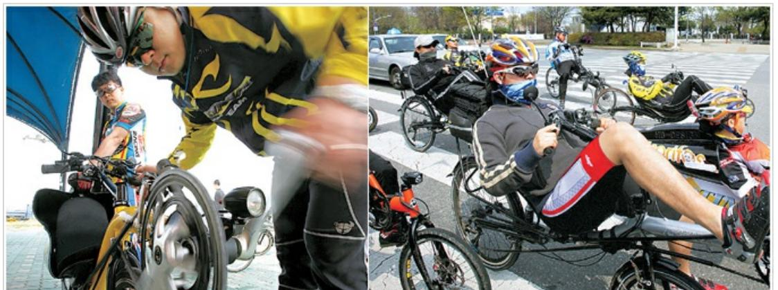
리컴버트 자전거는 ‘누운’이라는 뜻의 리컴버트(Recumbent)와 자전거(Bike)의 합성어로, 누워서 타는 것은 단순한 자세의 차이가 아니다. 리컴버트 자전거 마니아들은 “편안할 뿐만 아니라, 스피드 면에서도 다른 자전거에 뒤지지 않는다”고 입을 모은다. 허리를 앞으로 굽히기 때문에 등과 허리에 무리를 주는 일반 자전거와 달리 리컴버트 자전거는 다리를 앞으로 쭉 뻗고, 넓고 폭신한 안장에 등을 기대어 운전하는 독특한 자세 때문에 등과 허리로 체중이 분산된다. 그래서일까. 오래 타도 피곤하지 않기 때문에 체력만 뒷받침되면 하루 종일 자전거를 타도 거뜰하다.
